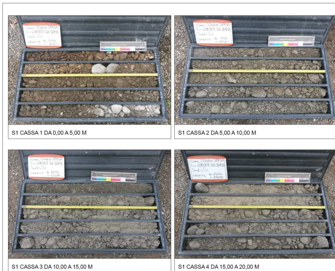
Fig. 4: Cassettes del sondaggio per le profondità comprese tra 0 e 20 metri da p.c.
